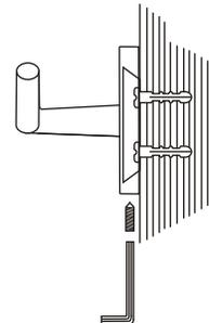
5.- Para el caso de la barra toallero colocar la barra en el orificio del soporte instalado e insertar el otro soporte en el otro extremo de la barra y presentarlo sobre el muro para marcar los orificios del ancla y proceder a instalar ver paso 2, 3 y 4.
