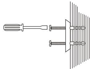
4.- Colocar el soporte sobre la base del ancla y roscar el opresor con la ayuda de la llave hexagonal para asegurar que no se gire el accesorio.
