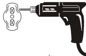
3.- Introducir los taquetes en los orificios del muro y colocar el ancla haciendo coincidir los barrenos con los taquetes y atornillar las pijas.
