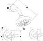
Caracteristicas Rosca para instalación a la red hidráulica 1/2-14 NPT
