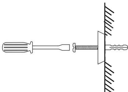
3.- Introduzca los taquetes en los orificios del muro y coloque el ancla haciendo coincidir los barrenos con los taquetes y atornille la pijas.
