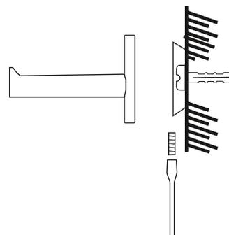
4.- Coloque el accesorio sobre el ancla y con la ayuda de un desarmador plano apriete el opresor para fijar el accesorio.
