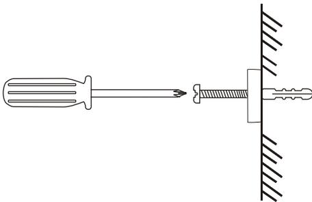
3.- Introduzca los taquetes en los orificios del muro y coloque el ancla haciendo coincidir los barrenos con los taquetes y atornille la pijas.
