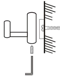
4.- Coloque el accesorio sobre el ancla y con la ayuda de la llave hexagonal apriete el opresor para fijar el accesorio.
