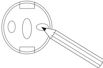
1.- Coloque el ancla con la cara lisa contra el muro (a la altura deseada) y marque los barrenos en el muro.
