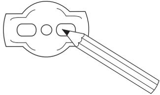
1.- Coloque el ancla con la cara lisa contra el muro (a la altura deseada) y marque los barrenos en el muro.
