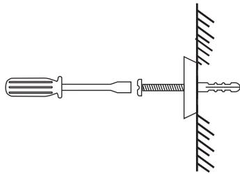
3.- Introduzca los taquetes en los orificios del muro y coloque el ancla haciendo coincidir los barrenos con los taquetes y atornille la pijas.
