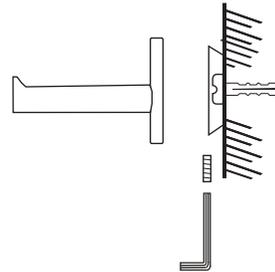
4.- Coloque el accesorio sobre el ancla y con la ayuda de una llave hexagonal apriete el opresor para fijar el accesorio.
